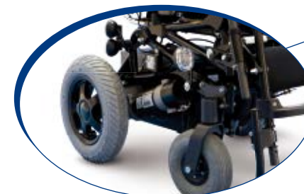
wahlweise Elektroantrieb mit leistungsstarken Motoren und Batterien
